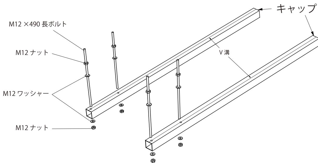
**4** M12 長ボルトに対して、偏心基礎金具の両側からナットとワッシャーで固定します。
