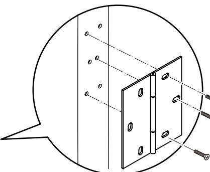
※ヒンジを取付ける向きによって使用するネジ穴が変わります
